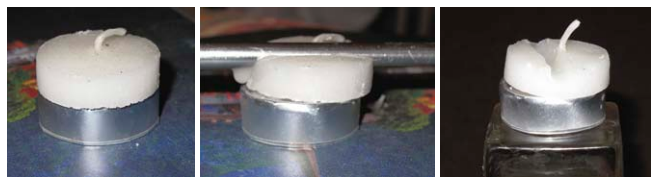
Токоотвод, нагретый до 225 °С, не оставляет след в пластиковом держателе Фото 2
