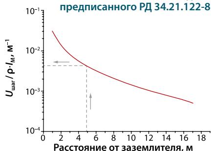
Рис. 1 Распределение напряжения шага в окрестности типового заземлителя молниеотвода, предписанного РД 34.21.122-87
